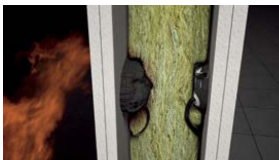
Демонстрація вогнестійкості приладової коробки.
